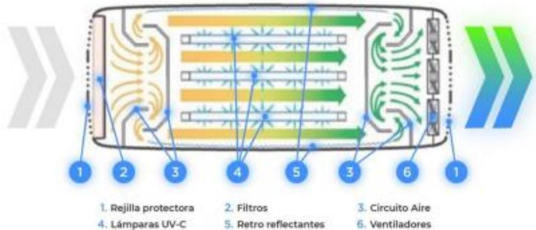
Nuestra solución permite que el flujo de aire circule a través del interior de los equipos, pasando previamente por unos **filtros G4** que retienen el polvo, para después atravesar la **cámara de luz ultravioleta** donde se produce la inactivación de los microorganismos, tras este proceso se expulsa el aire completamente esterilizado.
